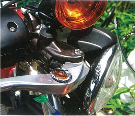
フロントブレーキにニッシン製ラジアルマスターシリンダーを奢ってやった。レバータッチが格段によくなったぞ
